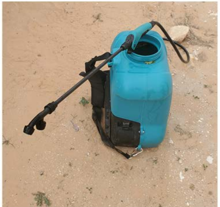
איור 1. מרסס הגב שהוכנס בו מחולל אוזון והריסוס האינטנסיבי על הצמחים.
