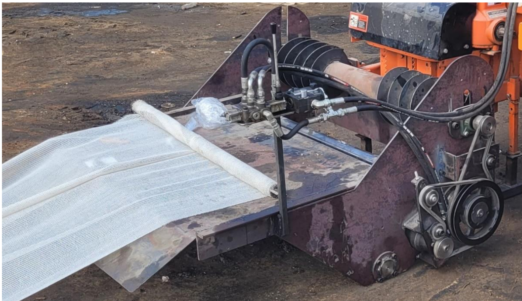
איור 2. מערך גלילה עם שולחן לחיבור קצוות הרשת; גליל שעליו מותקנים שני חלזונות למרכז הגזם
