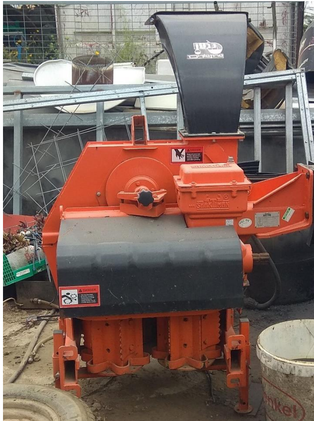
איור 1. מכונת קיצוץ בעלת שני גילי הזנה - פיזרים (בחלק התחתון), תוף קיצוץ פנימי בעל 6 סכינים וארובה להוצאת הגזם
