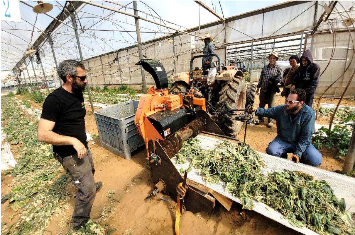
איור 7. משיכת הרשת, הנעת הגזם ומרכזו על ידי חילוץ ישירות אל פתח הזנת מערכת הקיצוץ; הגזם המקוצץ נזרק אל הדולב
