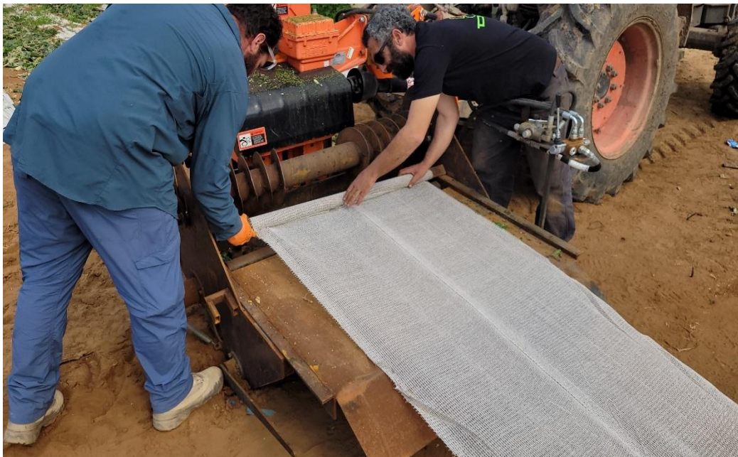
איור 6. התקנת קצה הרשת במערכת הגלילה (בקצה כל רשת מחובר מוט להתקנה ולשליפה מהירה של הרשת ממערכת הגלילה)
